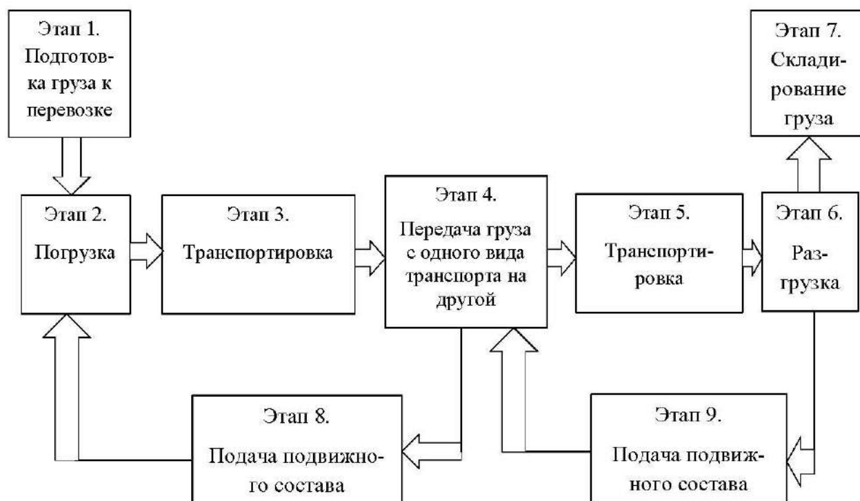
Рис. 1.1. Технологическая схема доставки груза с использованием нескольких видов транспорта
