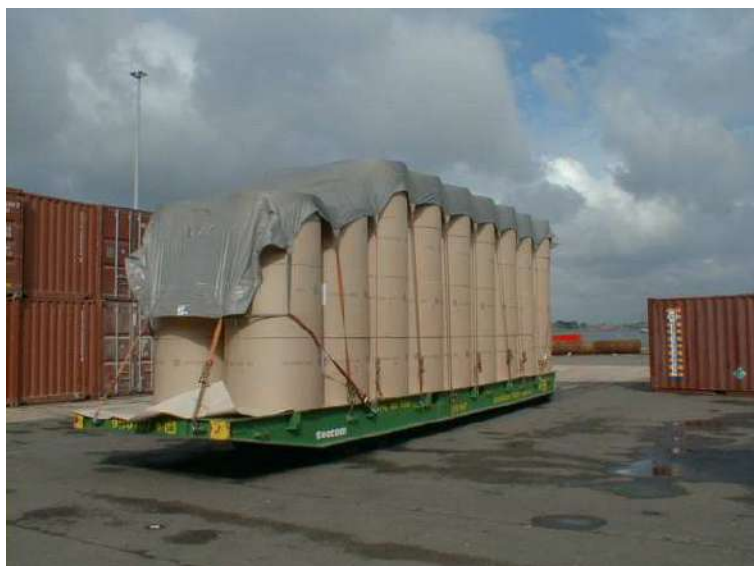
Рис. 3.12 Загруженный и закрепленный груз на ролл-трейлере
