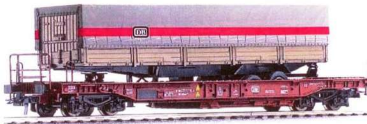
Рис. 3.9 Универсальная платформа, используемая при перевозке съемных кузовов
