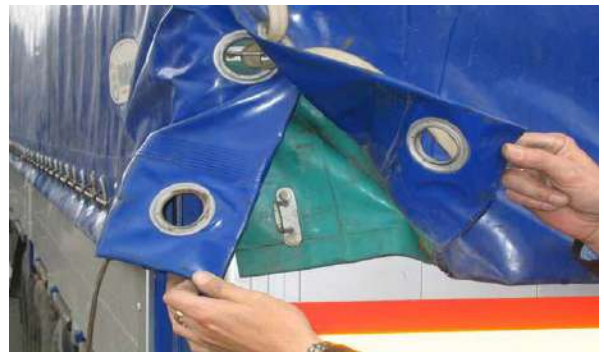
Рисунок 6.4 (б) – Відсутність кілець або брезент не відповідає причепу
