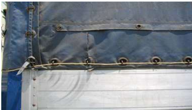
Рисунок 6.4 (а) – Відсутня проушина, незначне пошкодження брезенту
