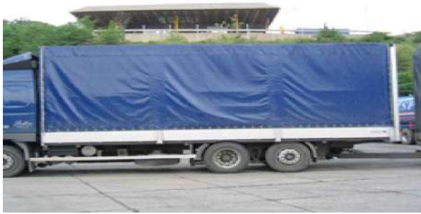
Рисунок 6.3 (в) – Брезент пошкоджено під час перевезення вантажу. В залежності від характеру вантажу даний причіп може бути допущений до продовження перевезення але з подальшим ремонтом
