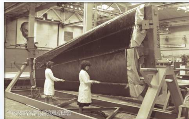
Намотка утеплителя на оправку отсека киль
