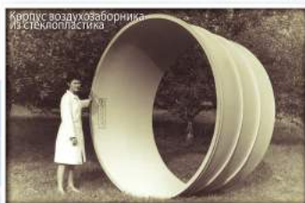
Мотогондола с панелями из стеклопластика
