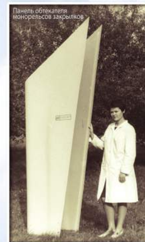
Люковая панель обтекателя шасси из углепластика
