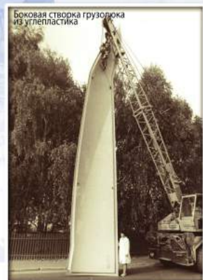
Хвостовая часть фюзеляжа, боковая створка грузолота
