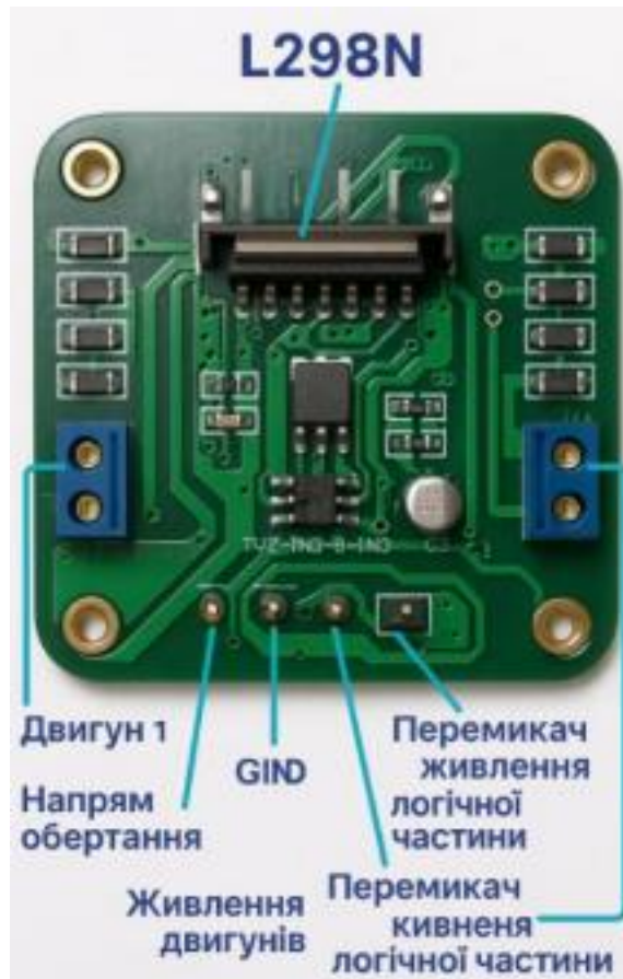
Рисунок 1.6 – Розташування ключових компонентів на платі L298N [3]
