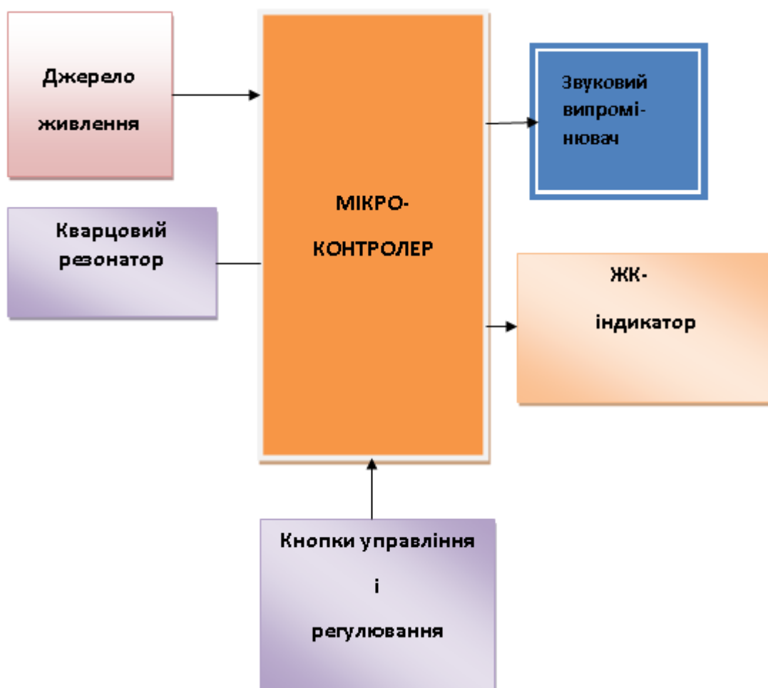
Рисунок 2.1 - Схема конструкції багатofункціонального астрономічного годинника
