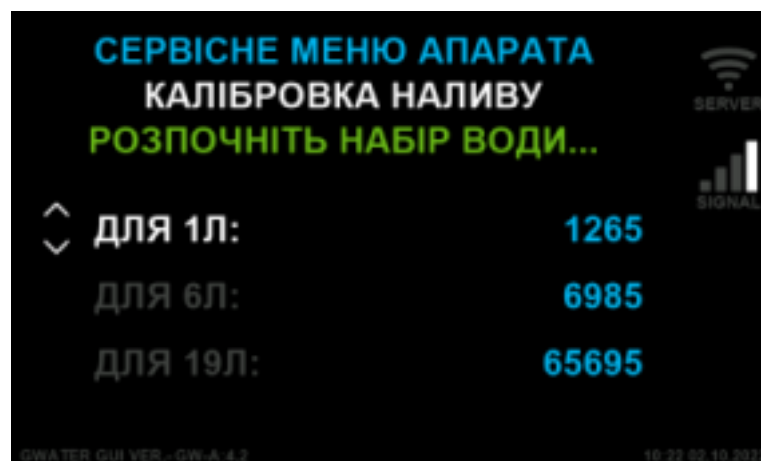
Рисунок 3.5 – Меню для здійснення калібрування датчика наливу води
