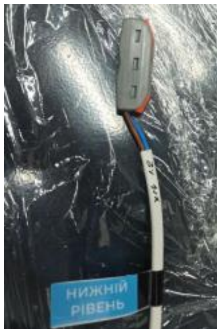
Рисунку 3.3 – Підключення датчика нижнього рівня води
