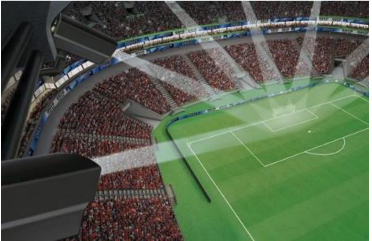
Рис.2.1 Система визначення голу GoalControl
