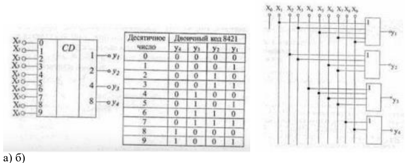
Рисунок 2.1 – Позначення шифратора на функціональних схемах: а) таблиця роботи б) і логічно-функціональна схема
