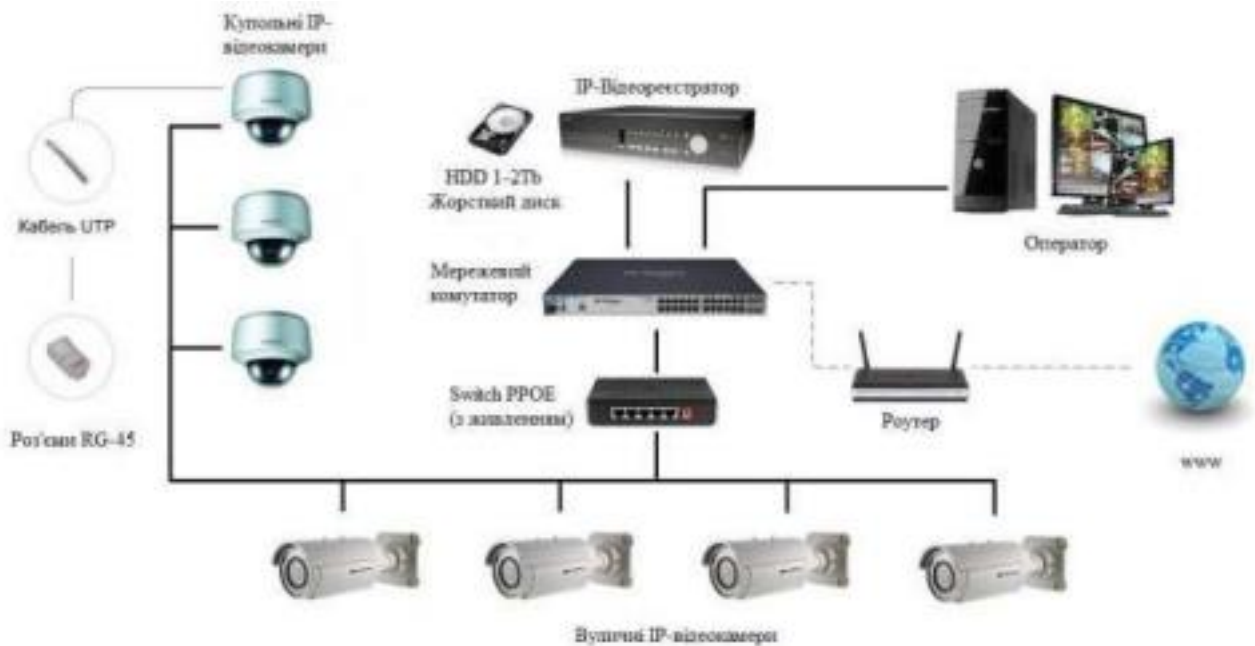
Рисунок 1.9 - Структурна схема системи цифрового відеоспостереження.
