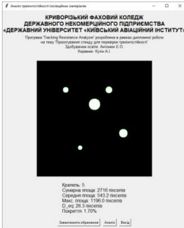
Рисунок 3.8 – Зразок зображення з накладеними об'єктами аналізу: зелені контури – виявлені плями/треки
