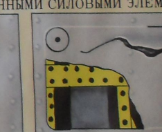
В углах размеченного контура вырезать квадратные отверстия, вырезать циркулярным резаком (R > 15 мм). Прорезать обшивку фрезой, вращающейся кругом или резаком, не повреждая элементов каркаса. Отделить обшивку от каркаса.
