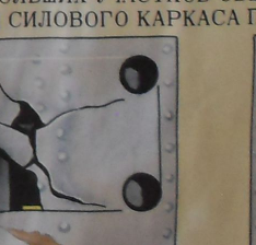
В углах размеченного контура вырезать квадратные отверстия, вырезать циркулярным резаком (R > 15 мм). Электролобзиком или ножовкой вырезать поперек.
