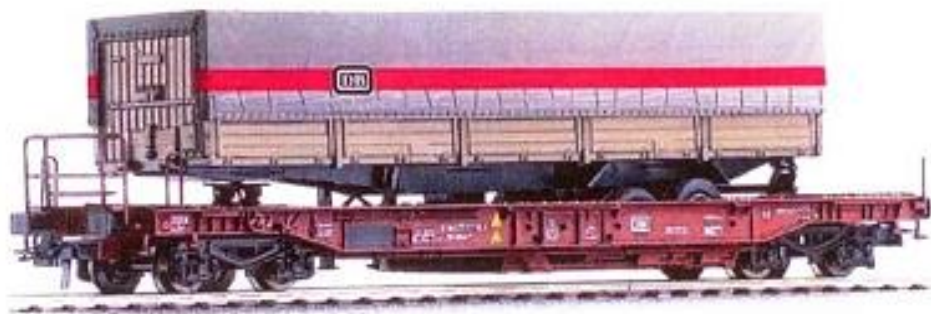
Рис. 8 – Універсальна платформа, яка використовується при перевезення знімних кузовів
