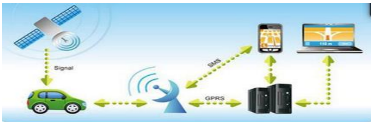
Рис. 3.2 – Принцип роботи GPS трекера
