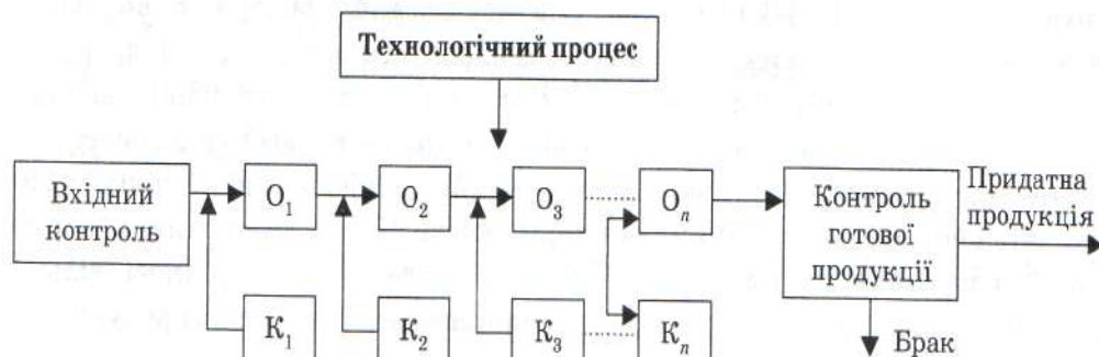
Рис. 2 – Схема регулювання якості у процесі виробництва за допомогою статистичного контролю:
