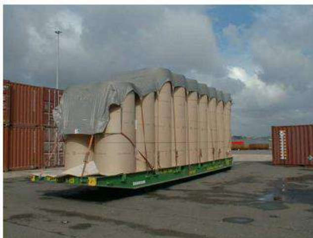
Рис. 11 – Завантажений і закріплений вантаж на роллтрейлері
